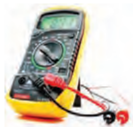
شکل ۵-۶ نمونه‌هایی از آمپرسنج
