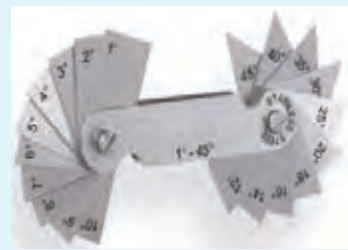
شابلون زاویه (اندازه‌گیری زاویه قطعات)
