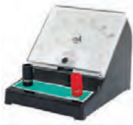
شکل ۵-۶ نمونه‌هایی از آمپرسنج
