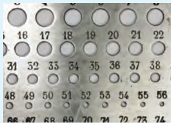
شابلون میله (اندازه‌گیری قطر میله‌ها)
