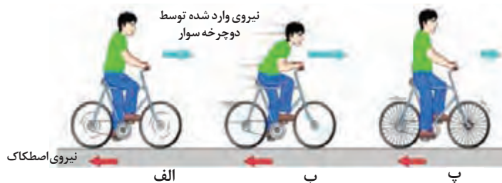
شکل ۲-۱۶ حرکت‌های یکنواخت، تندشونده و کندشونده دوچرخه
