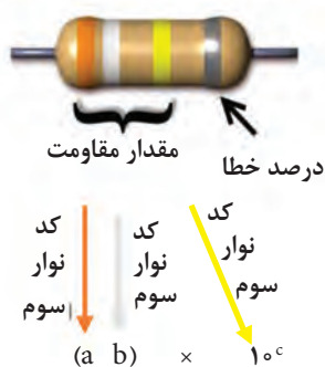
شکل ۵-۱۶ نحوه خواندن مقاومت رنگی
