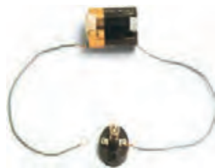
شکل ۵-۸ قطع شدگی در مدار
