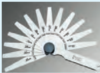
شابلون فیلر (اندازه‌گیری شکاف‌ها و شیارها)
