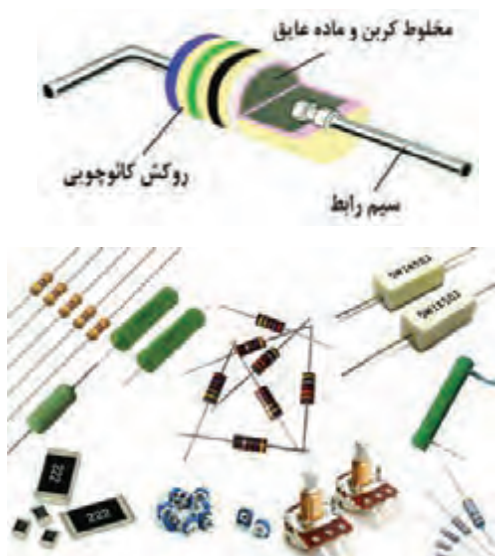
شکل ۵-۱۵ انواع مقاومت ثابت
